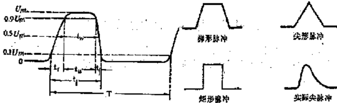
图 4-1 正脉冲的参数
